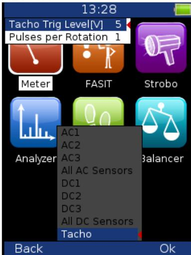
**Tacómetro Trig Level** El valor correcto de referencia debe ser configurado para la medición de la velocidad. Por ejemplo, cuando el nivel estándar del tacómetro es 0.5V y las pulsaciones alcanzar el 1.5V, por lo tanto, el valor 1V debe ser correcto. No se permiten pulsaciones negativas, para ello, necesitara utilizar el convertidor de Adash.
