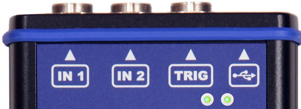
Las entradas etiquetadas IN1, IN2 son utilizadas para señales AC/DC. La entrada etiquetada TRIG es utilizada para señales de activación, usualmente el tacómetro (sonda de velocidad). Todas las entradas tienen diferentes pines. IN2 el permite al usuario conectar un sensor triaxial. Las entradas AC permiten la medición de un voltaje de pico máximo de +/-12V. La entrada DC permite la medición de un voltaje de pico máximo de +/-24V.
