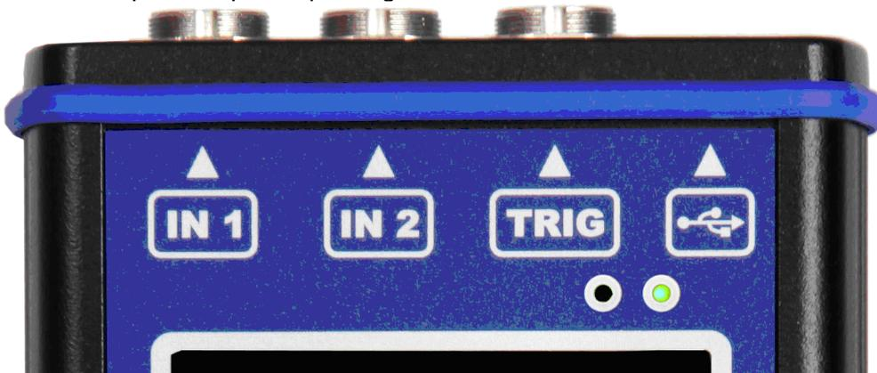
El LED del estado DSP se encuentra en LED derecho en la esquina superior derecha y le permite al operador monitorear el tablero del DSP. Se pueden mostrar diversos estados.
