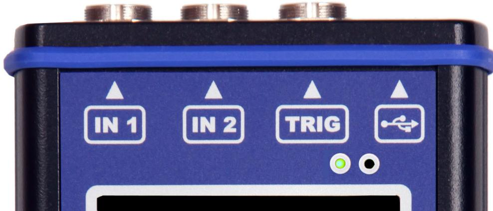
El LED del estado del CPU se encuentra en LED izquierdo en la esquina superior derecha y le permite al operador monitorear el CPU. Si este LED parpadea (como una pulsación) el CPU esta trabajando adecuadamente.
