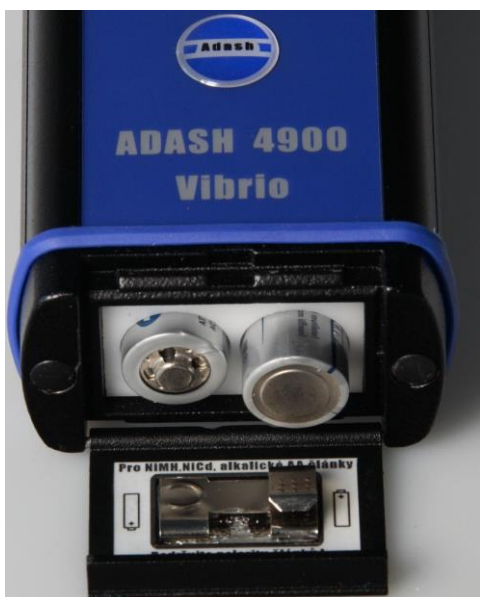
Obr. Umístění napájecích baterií
