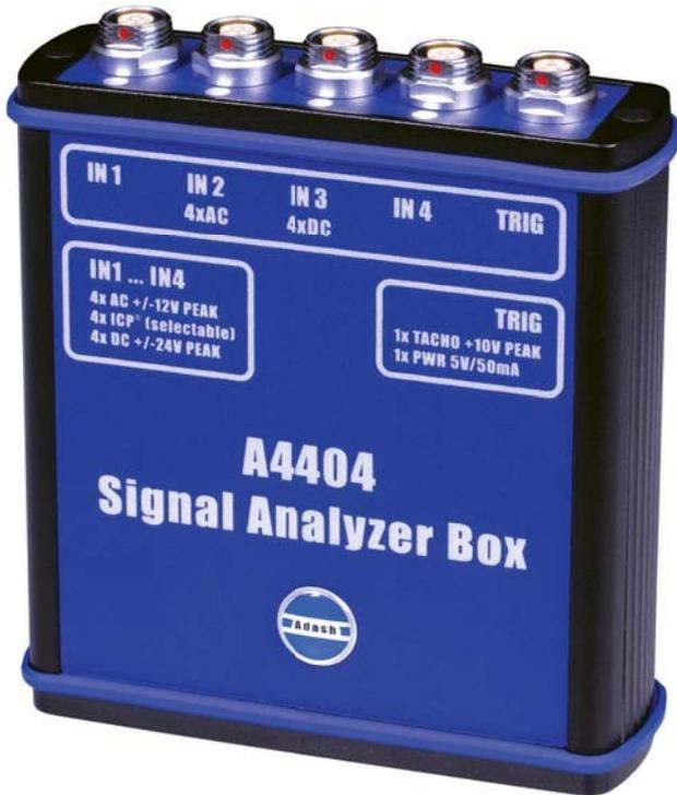
Der A4404 SAB ist identisch mit dem 4 Kanal Vibration Analyser, hat aber kein Display. Daher muss er zusammen mit einem Laptop oder PC genutzt werden.
