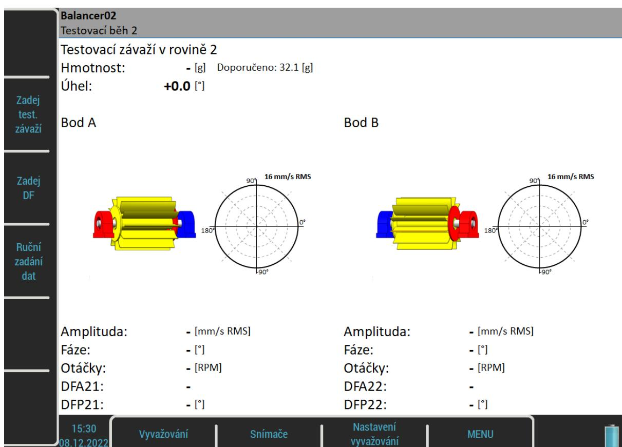
Stejná měření v obou bodech musíme provézt také pro testovací závaží v druhé rovině. Obrazovka vypadá stejně jako předchozí. Červeně je teď zvýrazněna druhá rovina. Zadejte hodnoty testovacího závaží a umístěte testovací závaží do druhé roviny. Proveďte měření pro oba body.
