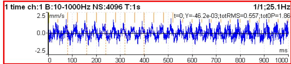
Nastavují se podobné parametry jako pro širokopásmovou hodnotu. Oranžové svislé čárky označují tacho vstupy (tzn. průchod značky na hřídeli před tacho sondou). Vedle hodnot kurzoru jsou zobrazeny hodnoty RMS (totRMS) a 0P (tot0P) zobrazeného časového signálu.
