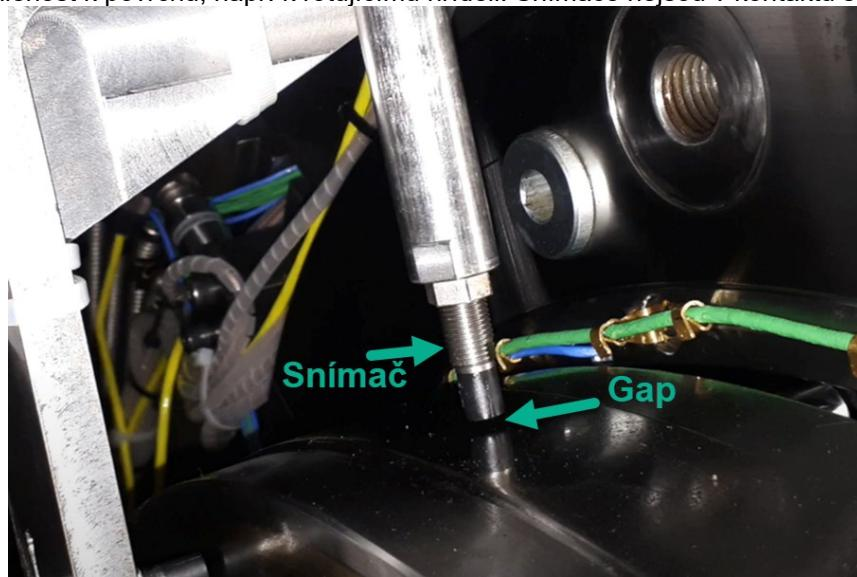
Signál vibrací rotujícího hřídele obsahují AC složku a DC složku. Např. AC složka reprezentuje vibrace. DC složka reprezentuje polohu hřídele.
