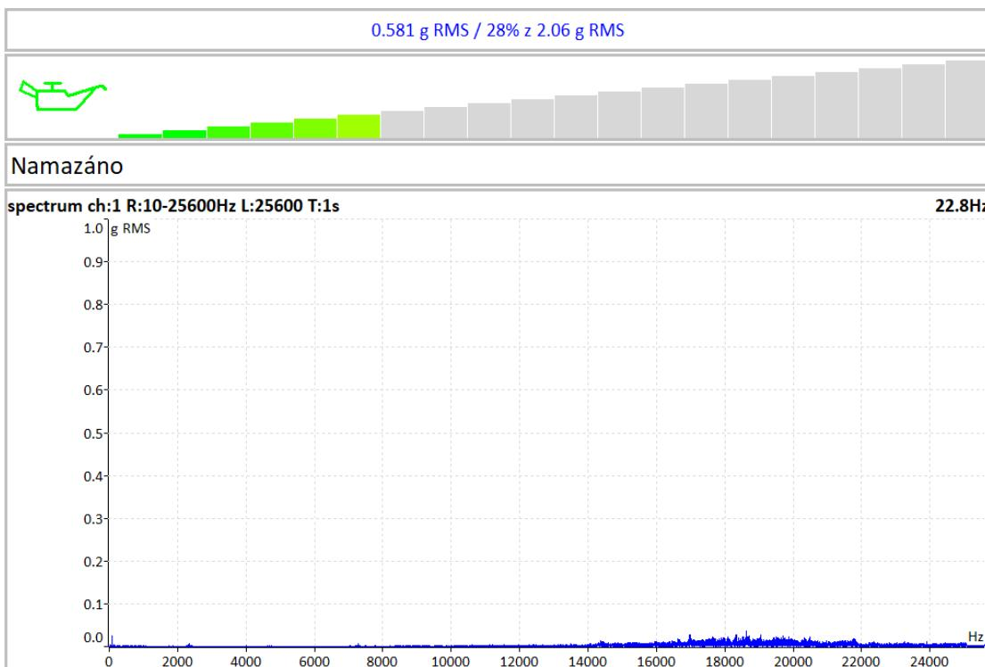
**Poznámka!** Je-li signál z ložiska již na začátku měření velmi nízký a hodnota na displeji je stále zelená, pak se jedná pravděpodobně o nové, nebo výborně namazané ložisko.
