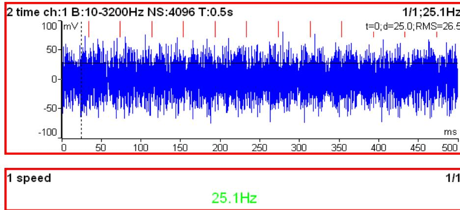
Měření otáček se provádí v odděleném procesu 8krát za sekundu. Hodnota otáček se počítá z každých příchozích tří pulsů. Lze zapnout průměrování.
