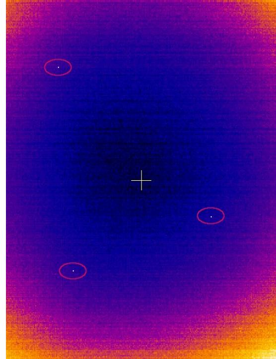
Během této kalibrace, jednoduše nastavte IR kameru, aby snímala jednotnou teplotní scénu. Pak stiskněte **Kalibruj** a obraz vy měl být opraven. Jednotná scéna by pak měla vypadat takto:
