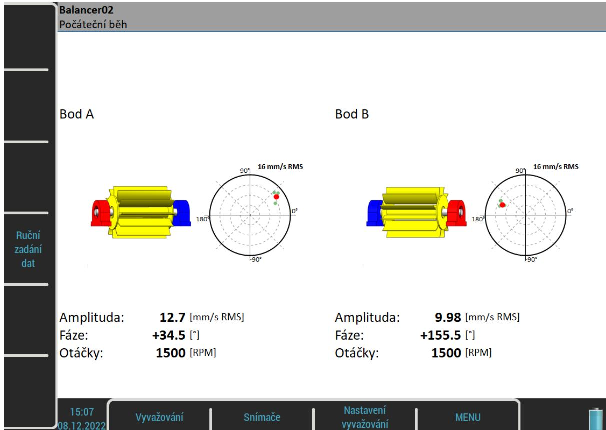
Červený bod v polárním grafu ukazuje aktuální hodnotu amplitudy a fáze v komplexní rovině. Menší zelené body ukazují všechny naměřené hodnoty během procesu měření, je-li [Režim měření](#) nastaven na **stálé měření**. Použijte šipku **Dolů** pro přechod na další obrazovku.
