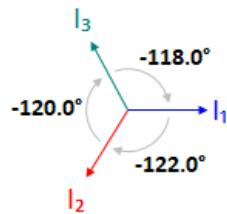
Můžete zkontrolovat fázový posun mezi fázemi. Navíc směr šipek ve fázorovém diagramu odpovídá směru otáčení motoru.
