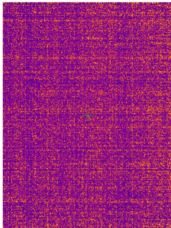
**Pozor!** Zkreslení IR obrazu může být způsobeno nedostatečným zahřátím IR kamery. Po připojení IR kamery počkejte alespoň 5 minut před zahájením korekce IR obrazu.
