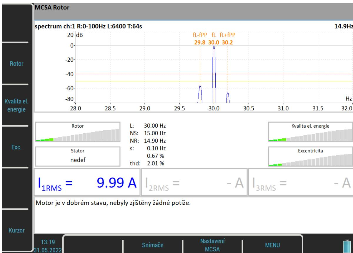
V případě měření jen jedné fáze nejsou zobrazeny všechny indikátory, chybí statorový diagram a hodnoty proudů. Není určena závažnost poruchy statoru.
