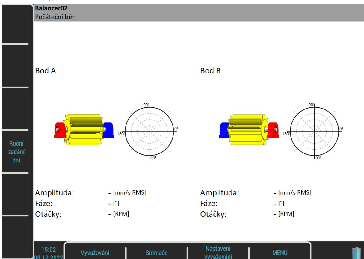
Červeně zbarvené domky jsou doporučená místa pro připojení snímačů. Můžete použít jakákoli jiná, pokud jsou vhodnější, tzn. např. jsou tam vyšší hodnoty vibrací. Polární graf slouží pro zobrazení naměřených hodnot. Pro zahájení měřícího procesu stiskněte tlačítko **Enter/Start**. Alternativou je **Ruční zadání dat**, kdy můžete zadat údaje z klávesnice. Lze tak použít přístroj jako tzv. vyvažovací kalkulačku.
