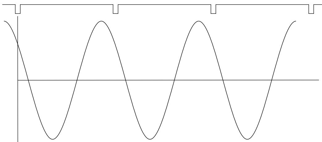
Časový signál předbíhá tacho značky o  $45^\circ$ . Hodnota fáze v měření 1x amp+fáze je v tomto případě  $45^\circ$ .
