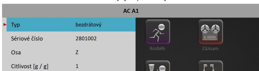
Definujte sériové číslo bezdrátového snímače a osu, která je přiřazena ke konkrétnímu měřícímu kanálu. Sériové číslo snímače a osy jsou umístěny na horní straně snímače.
