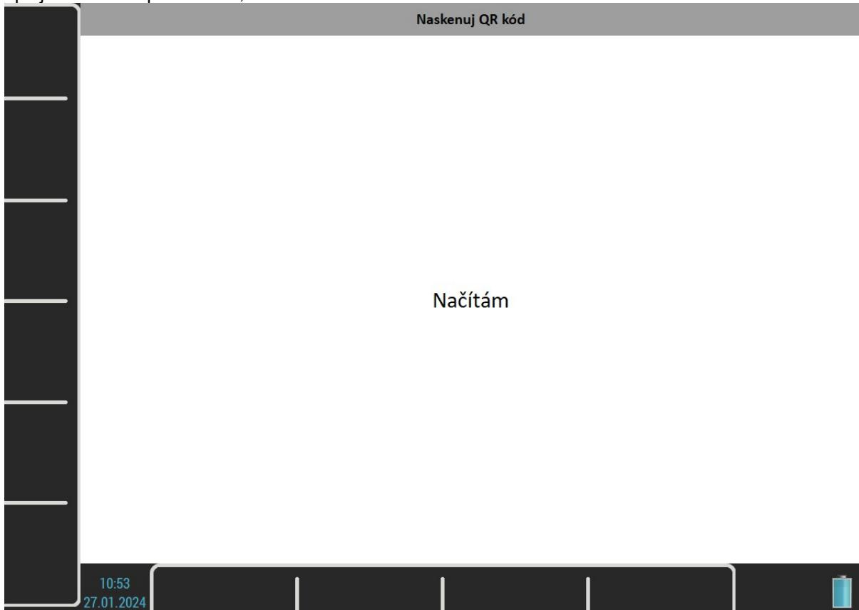
Jakmile uvidíte skrz kameru přístroje VA5, můžete ji nasměrovat na QR kód na stroji a ten bude naskenován zařízením VA5.
