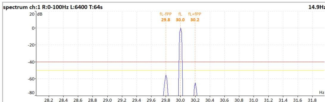
Jedná se o spektrum v blízkém okolí napájecí frekvence. Spektrum je zobrazeno v dB. Referenční hodnota je amplituda na napájecí frekvenci.
