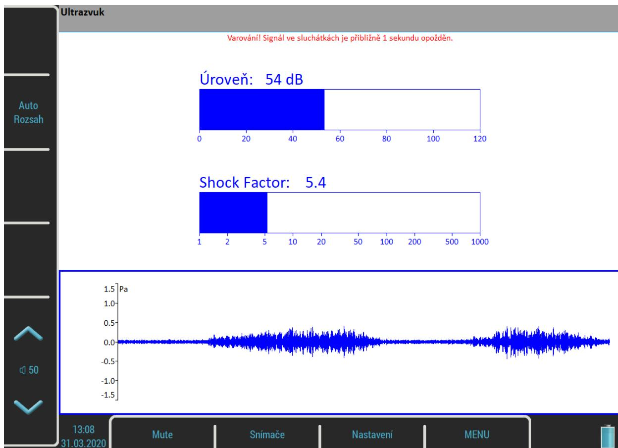
Pro zahájení měření stiskněte tlačítko *Enter*. V průběhu měření jsou zobrazen dvě hodnoty **Úroveň** zvuku v dB a tzv. **Shock Factor**. Jedná se o hodnotu, která charakterizuje zastoupení rázů v signále. Čím vyšší je číslo, tím více rázů signál obsahuje. Hodnota kolem 1.5 znamená čistý tón (sinový signál).
