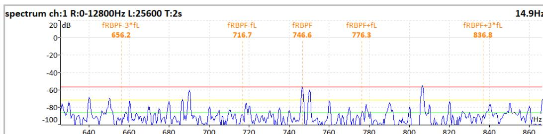
Zvýrazněny jsou frekvence charakteristické pro excentricitu, tzn. frekvence průchodu rotorové tyče (rotor bar pass frequency, **fRBPF**) a její liché postranní pásma (**fRBPF +/- fL** a **fRBPF +/- 3fL**). Dále jsou zvýrazněny limity pro určení excentricity.
