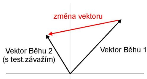
Procentuální hodnota je odvozena od poměru (amplituda změny vektoru/ amplituda vektoru Běhu 1).
