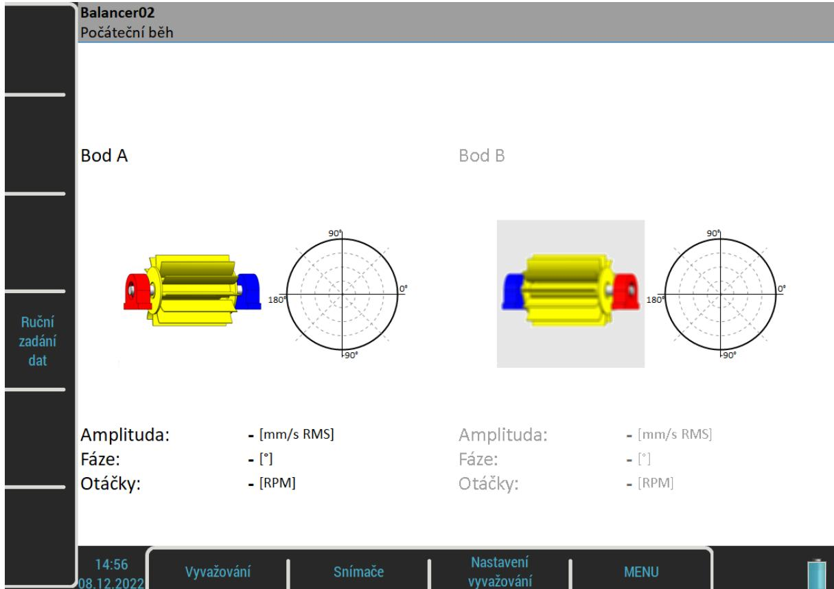
Jestliže měříte obě roviny najednou se dvěma snímači (hodnoty [Kanál pro bod A](#), [Kanál pro bod B](#) jsou různé) bude obrazovka vypadat takto:
