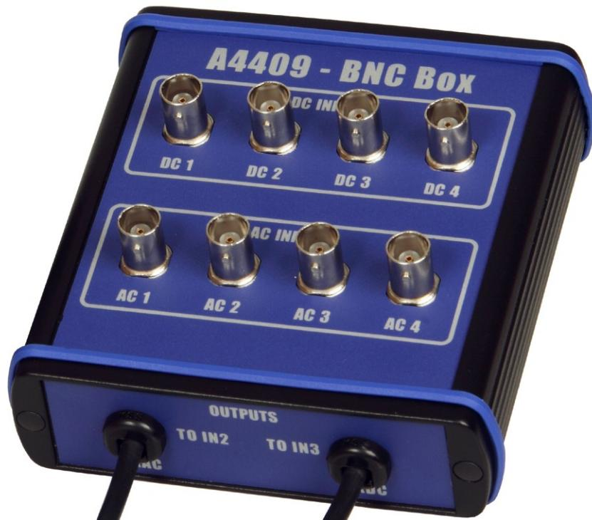
BNC Box umožňuje jednoduché propojení více kabelů s přístrojem VA5. BNC vstupy na horní straně, slouží k připojení 4 AC a 4 DC kanálů. Na bočním panelu jsou dva výstupní konektory, které slouží k propojení 4 AC kanálů do vstupu IN2 a 4 DC kanálů do vstupu IN3. Viz. předchozí kapitola o zapojení IN2 a IN3. Do vstupu IN2 můžou být zapojeny všechny 4 AC kanály a do IN3 všechny 4 DC kanály.
