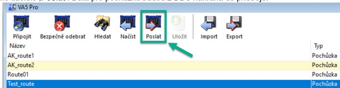
**Poznámka!** Když vytváříte pochůzku z části DDS stromu, může se někdy změnit struktura. To proto, že přístroj VA5 přísně vyžaduje strom se strukturou *Pochůzka – Stroj – Měřící místo (Měřící bod) – Měření*. Jsou-li v DDS stromu nějaké položky mezi těmito vyžadovanými, jejich názvy budou sloučeny, vznikne např. stroj s názvem *TG/Fans/Fan1* nebo měřící místo s názvem *Motor/L1RV* atd. DDS umožňuje nadbytečné položky z názvu vynechat.
