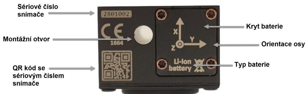
Montážní otvor je připraven pro šroub **M6 x 45 mm**. Pomocí tohoto šroubu můžete ke snímači připevnit magnet.
