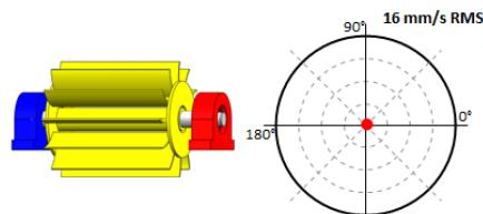
Amplituda: **0.5** [mm/s RMS]Fáze: **+11.0** [°]Otáčky: **1500** [RPM]Počáteční běh: **12.7** [mm/s RMS]Úspěšnost: **96.1** [%]Amplituda: **0.3** [mm/s RMS]Fáze: **+59.0** [°]Otáčky: **1500** [RPM]Počáteční běh: **9.98** [mm/s RMS]Úspěšnost: **97** [%]09:07
