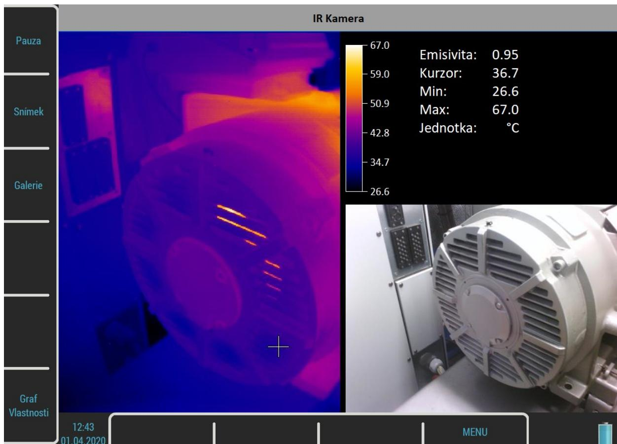
Na obrazovce vlevo je obrázek z IR kamery. Obrázek přibližně stejné scény, ale z optické kamery je vpravo. Nad ním je informační panel, kde vidíte minimální a maximální teplotu v místě kurzoru. Pro změnu polohy kurzoru použijte šipky, nebo klepněte na obrazovku.
