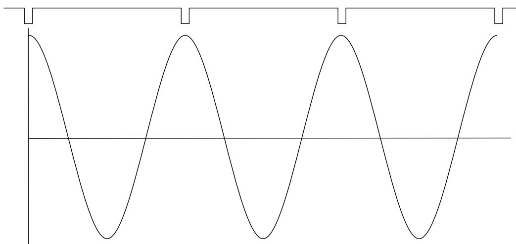
Nyní vezmeme v úvahu fázový posun mezi časovým a tacho signálem. Tento fázový posun značíme  $\varphi$ . Vzorec pro časový signál pro libovolný fázový posun zobecníme na  $y = \cos(\omega t + \varphi)$ . Předchozí vzorec odpovídal hodnotě  $\varphi = 0^\circ$ . Hodnotu  $\varphi$  můžeme na přístroji vidět při měření 1x amp+fáze. Jestliže tacho značky jsou v časovém signálu umístěny v maximech, pak je  $\varphi = 0^\circ$ .
