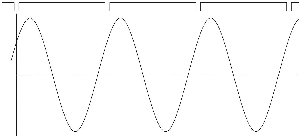
Časový signál je zpožděn. V měření 1x amp+fáze se v tomto případě zobrazí hodnota  $-45^\circ$ .
