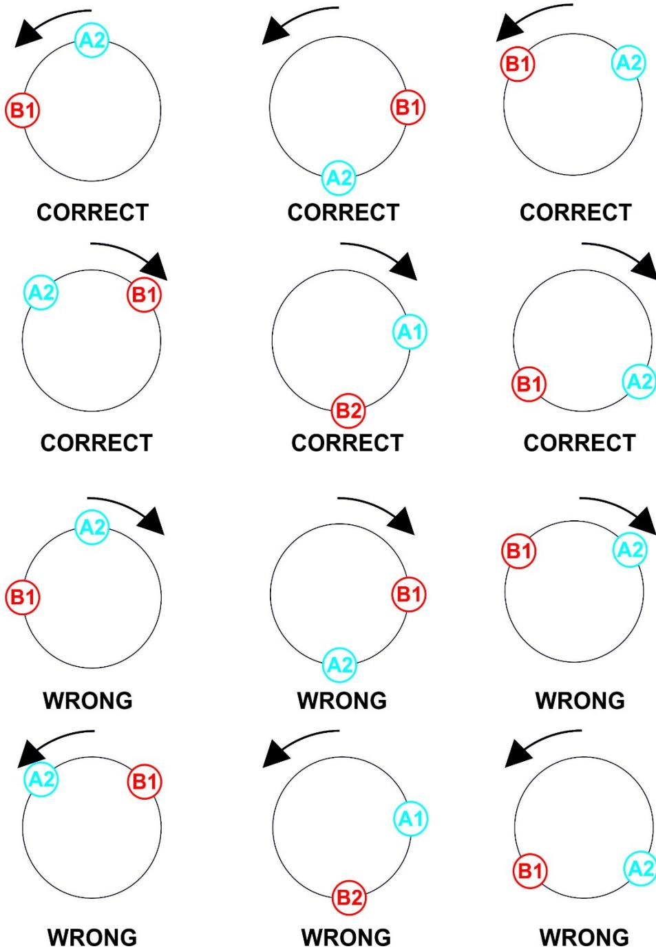
V následujícím měření je Pozice snímače AC1  $-90^\circ$  a Pozice snímače AC2  $180^\circ$ . Nastavení kanálu v měření full spektra i orbity je Kanál A na AC1 a Kanál B na AC2. V grafu orbity vidíte, že směr od A k B je proti směru otáčení hodinových ručiček (uvažujeme směr, ve kterém je úhel menší než  $180^\circ$ ) a to je směr otáčení hřídele. V tomto případě má šipka orbity stejný směr jako otáčky hřídele.
