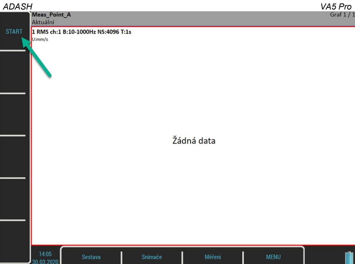
Dále vytvoříme druhé měření. Znovu vybereme **Měření / Nové rozšířené**. Parametr **Jednotka** změníme na **g**, **Pásмо fmin** na 500 Hz, **Pásmo fmax** na 25600 Hz a **Počet vzorků** na 65536. Uložte a druhé měření bude připraveno.
