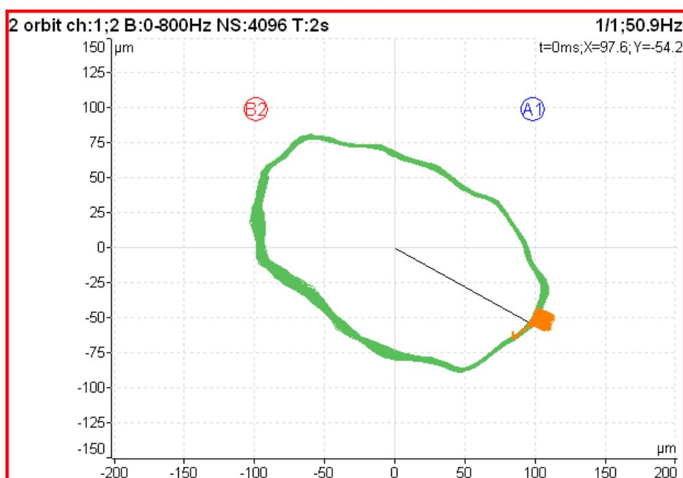
**A1** znamená, že [Kanál A](#) je nastaven na vstup AC1 a podobně **B2** znamená, že [Kanál B](#) je nastaven na vstup AC2. Polohy značek A1 a B2 odpovídají nastaveným úhlům snímačů v [Vlastnosti AC snímačů](#) / [Pozice](#). Znalost těchto úhlů umožňuje vykreslit správný tvar orbity.
