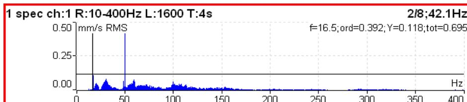
Údaje v pravém horním ukazují průměrování a otáčky. Pod nimi jsou údaje o kurzoru, frekvence (f), řád = f / otáčky (ord), a amplituda (Y) a celková hodnota spektra (tot). Kompletní seznam zkratek v grafu je v [Příloha C: Symboly a zkratky](#).
