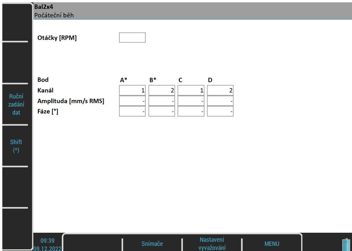
Nyní musíte provézt počáteční měření. Body A a B jsou označeny pro měření, jak bylo popsáno v [Základní nastavení / Kanál pro bod A, Kanál pro bod B](#). Nezapomeňte připevnit snímače na patřičné body na stroji. Měření zahájíte stisknutím tlačítka **Enter/Start**.
