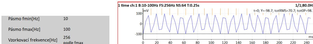
Jak vidíte na obrázku, je těžko rozpoznatelné, že se jedná o signál sinus. Bylo by lepší použít vyšší vzorkovací frekvenci. Když přitom stále potřebujete filtr s fmax 100 Hz, pak vám parametr **Vzorkovací frekvence** umožní zadat libovolnou vyšší vzorkovací frekvenci z řady a využít tzv. **nadvzorkování**. S nadvzorkováním je signál vykreslen přesněji.
