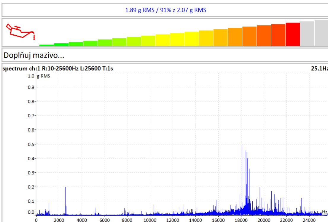
Přístroj kontinuálně měří hodnotu zrychlení g RMS v pásmu 500-25600Hz a porovnává ji s počáteční hodnotou. Na horním řádku displeje je zobrazen aktuálně měřená hodnota a její procentuální velikost vůči počáteční hodnotě. Pod hodnotou je zobrazen sloupec, jehož výška indikuje aktuální stav mazání ložiska. Po spuštění měření dosahuje sloupec vždy maximální úrovně.
