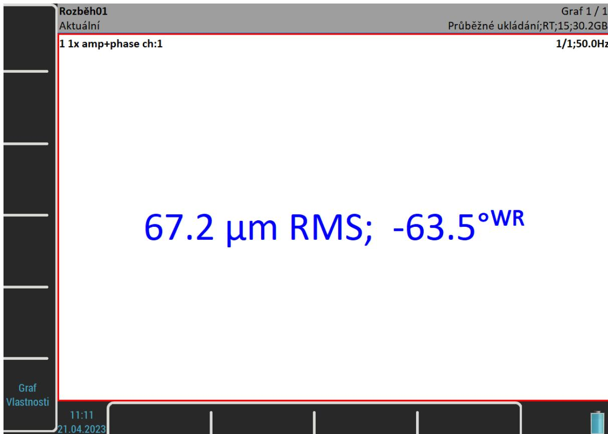
Během měření rozběhu se indikátor *Měření* ve stavovém řádku změní na *Průběžné ukládání* a obsahuje dodatečné informace, počet uložených hodnot (zde 15) a velikost dostupné paměti (zde 30,2 GB).
