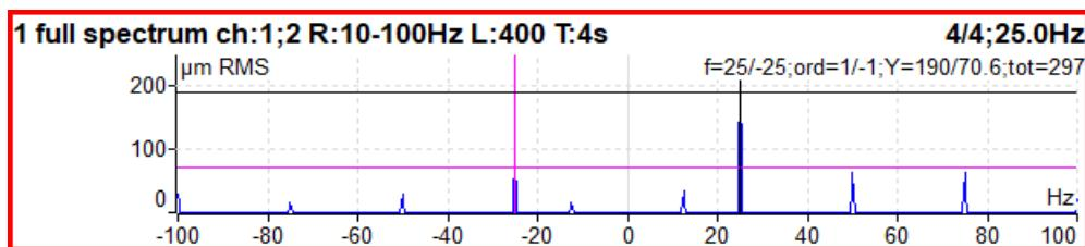
**Poznámka!** Ke kurzoru je automaticky zobrazen i kurzor s opačnou frekvencí (opačný kurzor). Je vykreslen odlišnou barvou (zde fialovou). Stavový řádek kurzoru je formátován tak, že před znakem / je vypsána hodnota kurzoru a za znakem / je hodnota opačného kurzoru.
