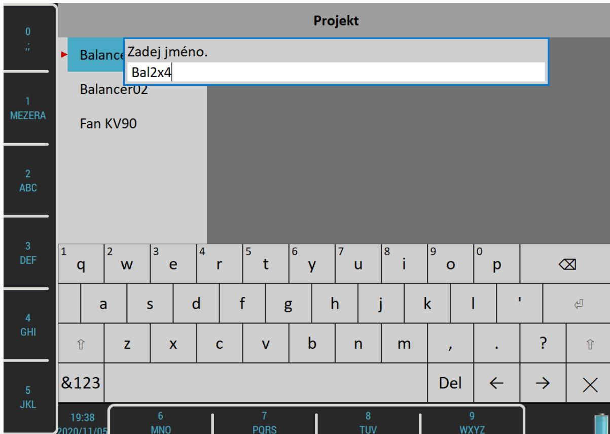
Otevřete nový projekt. Jelikož nemá žádná data, objeví se nejprve menu [Základní nastavení](#). V menu zadejte hodnoty [Roviny](#) na 2 a [Body](#) na 4. Budeme předpokládat použití dvou snímačů připojených na vstupech AC1 a AC2. Tedy nastavte čísla kanálů na 1 pro body A a C a na 2 pro body B a D. Ostatní hodnoty mohou zůstat výchozí.
