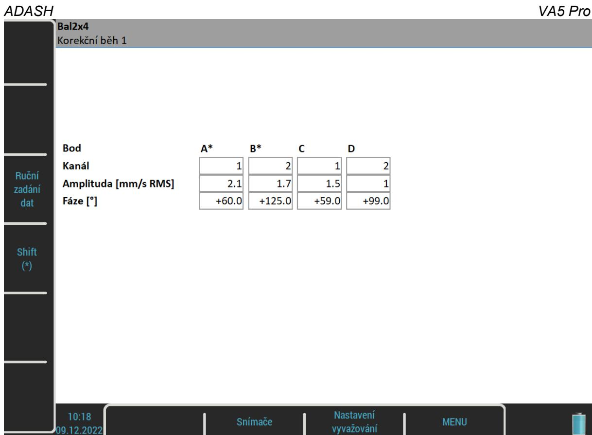
Jestliže nejste spokojeni s výsledky, můžete pokračovat dále (tlačítko *Dolů*). Tato další měření již nevyžaduje měření s testovacím závažím. Po odměření každého běhu je doporučeno další vyvažovací závaží. Pokud však již výsledek není lepší než předchozí, další běhu už nemají smysl.
