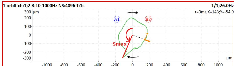
**Poznámka!** Pozice maximálního výkmitu nemusí být vždy jednoznačná. Jako příklad uvažujme orbitu ve tvaru kružnice (viz obrázek níže). Úhel Smax je v tomto případě náhodné číslo, a když tento Smax průměrujeme, pak je úhel nedefinovaný.
