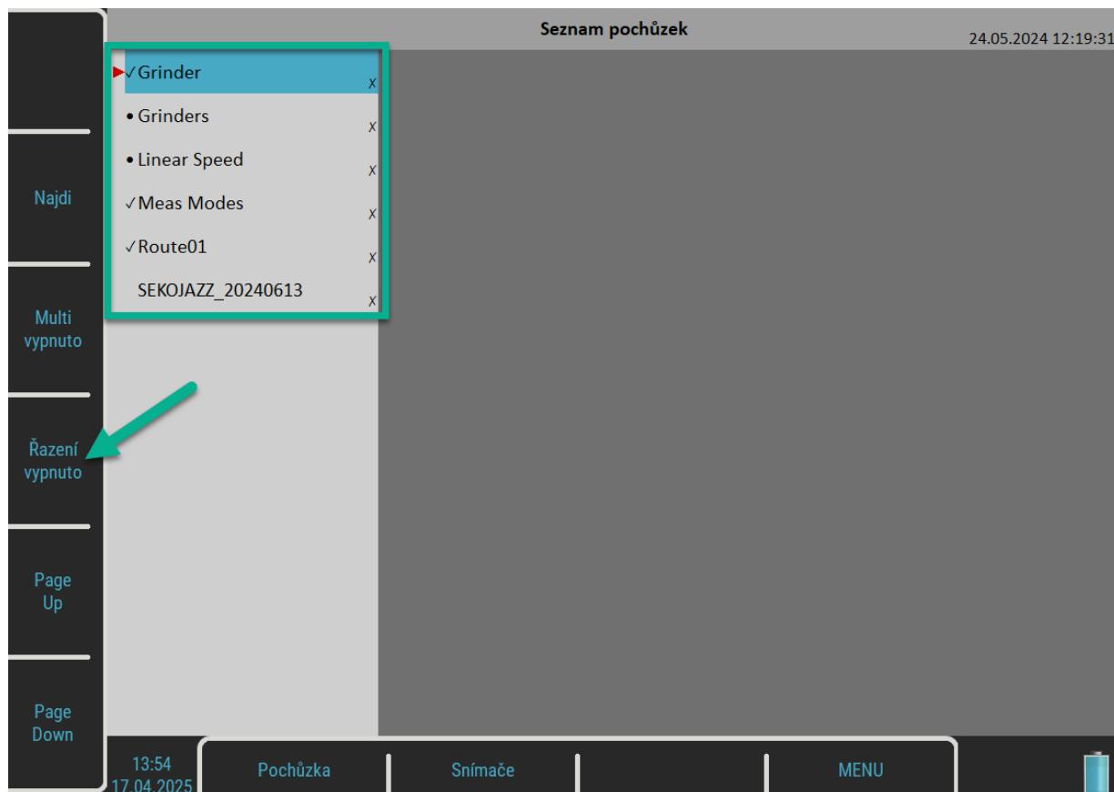
Když kliknete na tlačítko **Řazení vypnuto**, text se změní na **Řazení zapnuto**. Tím se zapne mód, ve kterém můžete libovolně měnit pořadí pochůzek. K tomu využijte šípky nahoru a dolů.
