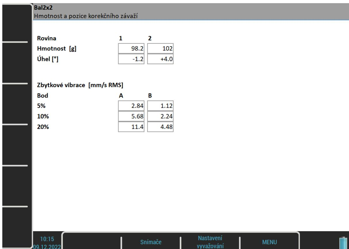
Je-li počet bodů roven počtu rovin nejsou žádné zbytkové vibrace. Nemusíte je minimalizovat, protože jsou všechny nulové. Proto je jen jeden výsledek. Nicméně stále má smysl zobrazit zbytkové vibrace reprezentující citlivost na umístění vyvažovacího závaží.
