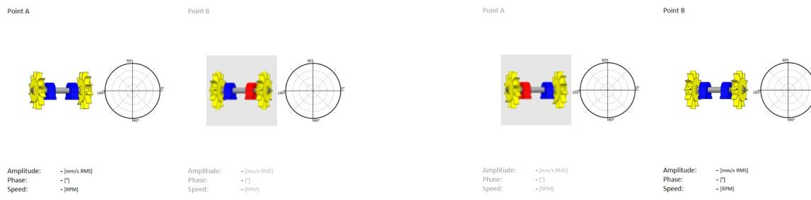
**Poznámka!** Značení měřících bodů písmeny A a B je pouze symbolické a nemá vztah k rovinám 1 a 2. Nemá také vliv na postup výpočtu vyvažovacího procesu. Písmenem A můžete označit kterýkoliv měřící bod a písmenem B druhý bod.
