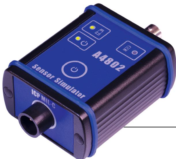
Der A4802 Simulator verhält sich wie ein Standard ICP Beschleunigungssensor mit einer Empfindlichkeit von 100 mV/g. Der Simulator generiert ein exaktes Beschleunigungssignal auf einer Frequenz von 80 Hz und 8 kHz.
