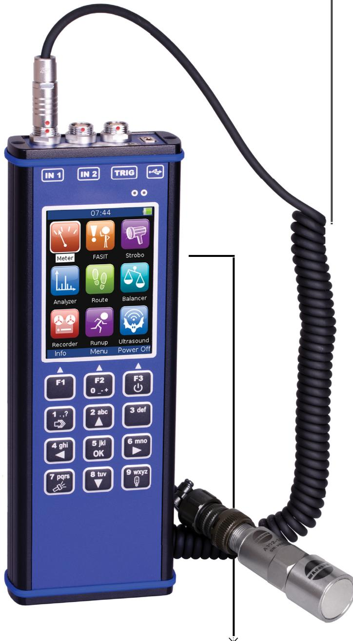
Das A4300 VA3 Pro hat zwei Signaleingänge, die simultan gemessen werden, plus einen zusätzlichen Eingang für einen Laser-Drehzahlsensor. Der zweite Eingang bietet die Möglichkeit auch einen Tri-axial Sensor anzuschließen. Damit ist es möglich alle drei Ebenen plus die Drehzahl simultan zu messen.
