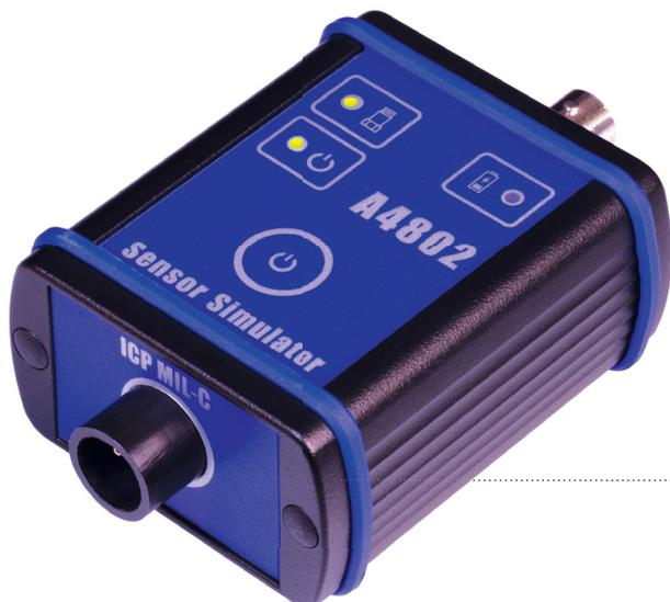
A4802 센서 시뮬레이터 장치는 감도가 100mV/g 인 표준 ICP® 가속 센서처럼 작동합니다. 이 장치는 80Hz 및 8kHz 주파수에서 정확한 진폭 레벨을 생성합니다. A4802 장치를 사용하면 분석기, 진동 측정기, 보호 및 모니터링 시스템의 측정 정밀도와 기능을 확인할 수 있습니다.
