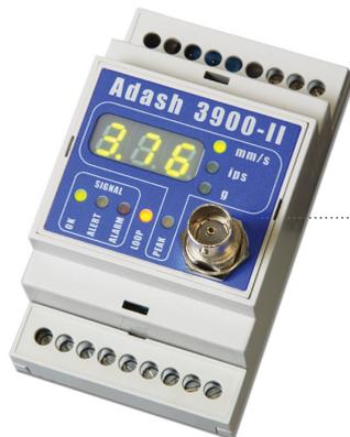
A3900은 간단한 1채널 온라인 모니터링 시스템입니다. 측정된 값은 전면 패널에 표시되고 4-20mA 전류 루프 출력을 통해 제어 시스템으로 전송됩니다. A3900 장치에는 프로그래밍 가능한 출력 "ALARM" 릴레이 1개가 포함되어 있습니다.
