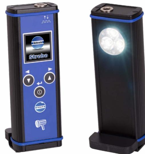
Das Stroboskop ermöglicht es, die rotierende oder translatorische (hin- und hergehende) Bewegung einer Maschine für das Auge zu stoppen. Es erlaubt auch, die Drehzahl zu ermitteln oder synchronisierte Messungen durchzuführen, ohne reflektierende Markierungen auf der Welle verwenden zu müssen.
