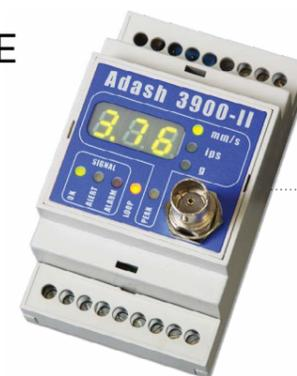
Das A3900 ist ein einfaches online Überwachungssystem. Das Messsignal wird auf der Anzeige an der Einheit angezeigt und gleichzeitig als 4-20 mA Signal ausgegeben. Das A3900 hat außerdem einen programmierbaren Alarmausgang.
