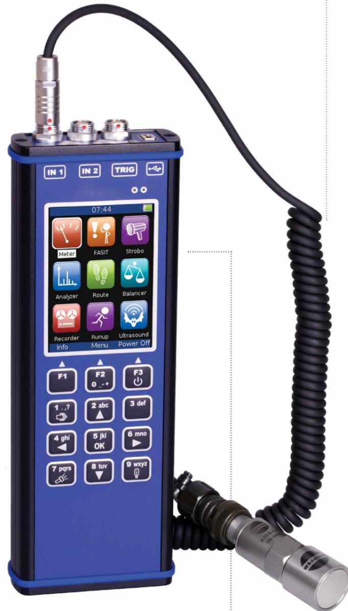
Das A4300 VA3 Pro hat zwei Signaleingänge, die simultan gemessen werden, plus einen zusätzlichen Eingang für einen Laser-Drehzahlsensor. Der zweite Eingang bietet die Möglichkeit auch einen 3-axial Sensor anzuschließen. Damit ist es möglich alle drei Ebenen plus die Drehzahl simultan zu messen.
