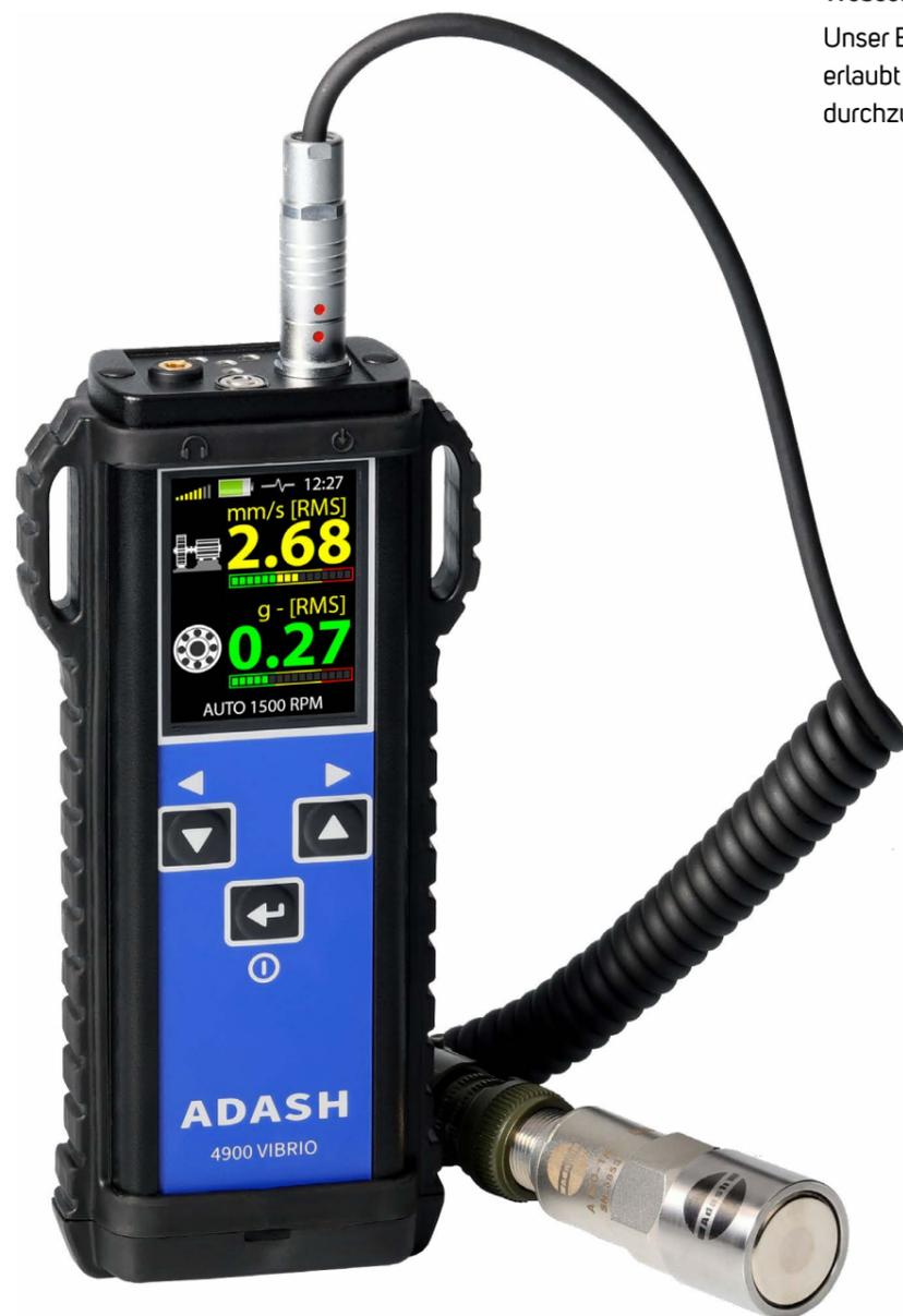
Das A4900 Vibrio M erlaubt es alle grundlegenden Vibrationsanalysetools anzuwenden. Hierzu gehören die Analyse der Lagerzustände, die Identifikation von mechanischen Schäden sowie die Ermittlung von Schmierzuständen.
